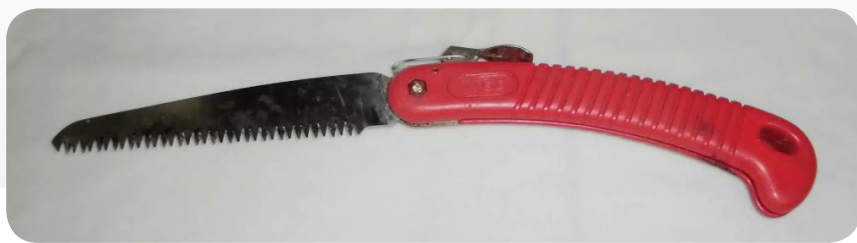
Figura 2. Cuchillo dentado para simular corte con motosierra
